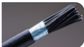
BLFA: Blindagem em fita de alumínio/poliéster (sobreposição mínima de 25%) com condutor dreno em cobre estanhado.
